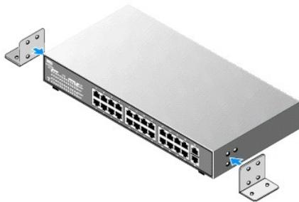
3. スイッチを壁面に配置して位置決めを行い、壁面にブラケットの穴の位置を示す印を付けます。
